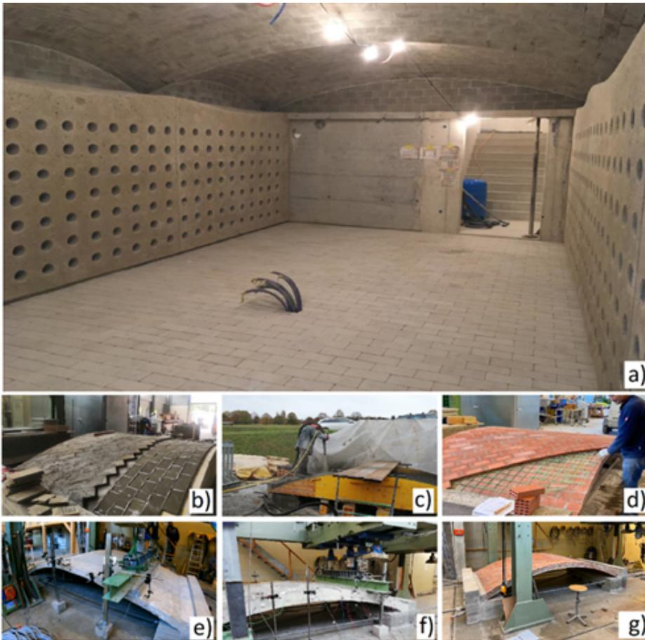
(a) Réalisation d'un abri non chauffé en échelle réelle; fabrication et essai mécanique de l'abri témoin réalisé selon la technique Catalane en (b, e) brique de terre crue, (c, f) shot-earth, (d, g) brique de terre cuite (en cours)
